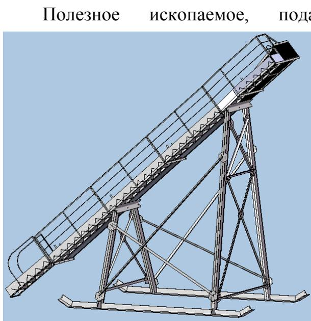
Рис. 1. Модель грохота наклонного колосникового
