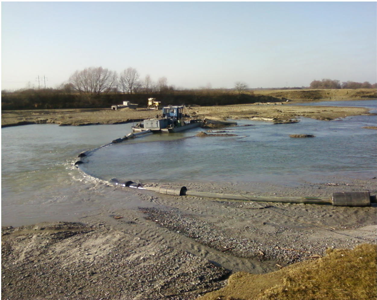
Рис. 2. Эжекторный земснаряд ЗНС 630-90
