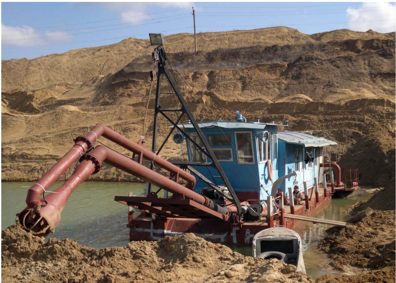
Рис. 2. Эжекторный земснаряд ЗНС 300-120
