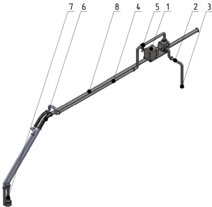
Рис. 1. Гідравлічна система ежекторного земснаряду ЗНС 300-120: 1 – водяний насос; 2 – усмоктувальний патрубок; 3 – зворотний клапан; 4 – напірний водопровід; 5 – засувка; 6 – гнучкий трубопровід; 7 – ґрунтозабірний пристрій СГЗ 300-120; 8 – напірний пульпопровід
