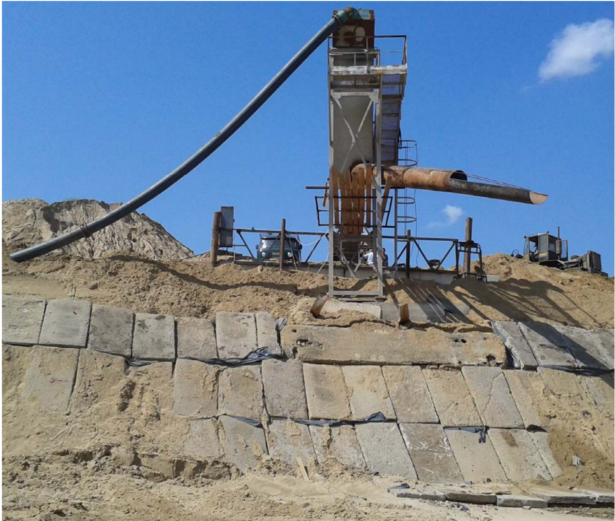
Рис. 2. Мийка піску гравітаційна МПГ-1600 на промисловій ділянці кар'єру Східно-Бузького-2 родовища піску
